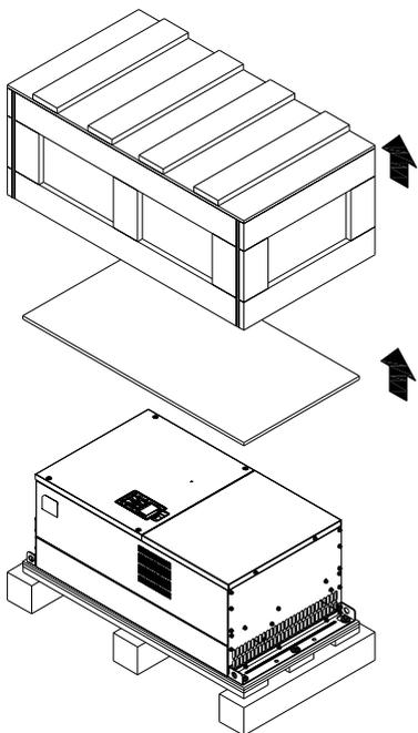
Снимите крышку ящика, извлеките пенопластовые и резиновые уплотнители и техническую документацию.
