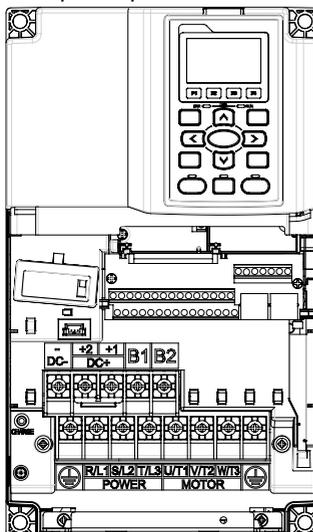
Силовые клеммы: R/L1, S/L2, T/L3, U/T1, V/T2, W/T3, ⊕, ⊖, B1, B2, +1, +2, -
