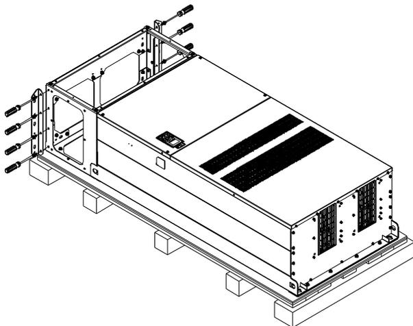
Снимите преобразователь с паллеты, закрепившись за специальные отверстия. После этого он готов к монтажу.
