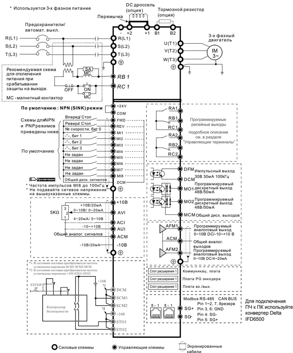
\*1: В состоянии поставки преобразователя частоты установлена перемычка SCM1-SCM2-DCM.
