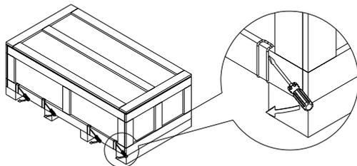
Снимите крышку ящика, извлеките пенопластовые уплотнители и техническую документацию.
