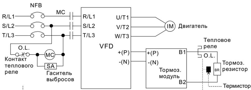
Прим.1: Когда используется ПЧ с дросселем постоянного тока, см. схему подключения в руководстве по эксплуатации ПЧ для подключения клеммы +(P) торм. модуля.
