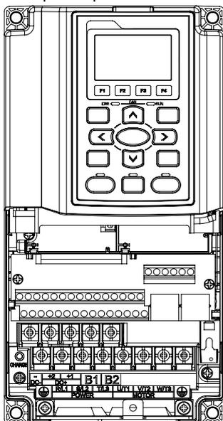
Силовые клеммы: R/L1, S/L2, T/L3, U/T1, V/T2, W/T3, ⊕, ⊖, B1, B2, +1, +2, -
