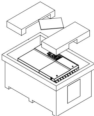
Открутите 8 винтов, закрепляющих преобразователь на паллете, удалите деревянные планки.
