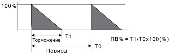
2. Для предотвращения перегрузки тормозного резистора рекомендуется установить в его цепи тепловое реле. Контакт теплового реле должен отключать ПЧ с помощью контактора (MC) от питающей сети!
