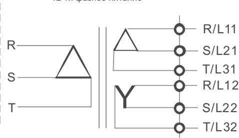
При шестипроводном питании необходимо снять перемычки с клемм R, S, T.
