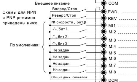
\* Частота импульсов MI8 до 100кГц
