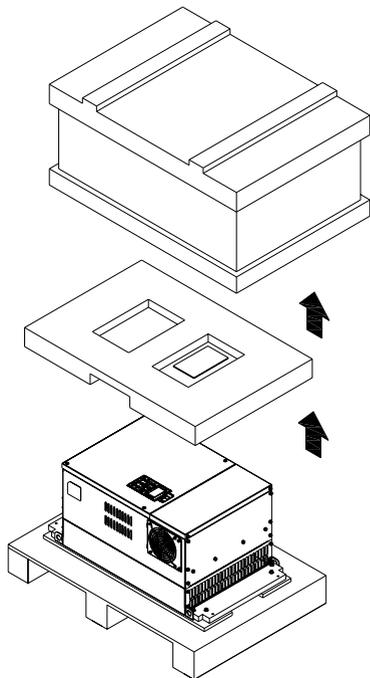
Снимите крышку ящика, извлеките пенопластовые и резиновые уплотнители и техническую документацию.
