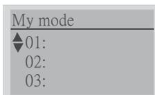
Если нажать кнопку F4 на странице выбора параметра, то он сохранится в разделе "Мой режим". Для удаления или изменения параметра выделите его и нажмите "DEL" в правом нижнем углу.
