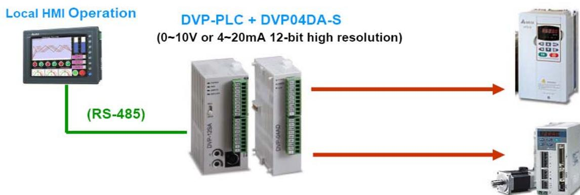
2. Наличие инкрементальных команд позиционирования позволяет контроллерам Дельта с высокой точностью управлять сервоприводом, задавая ему необходимую величину подачи пакетов, которая определяет размер пакета. При этом достигается точность в пределах 1 мм.
